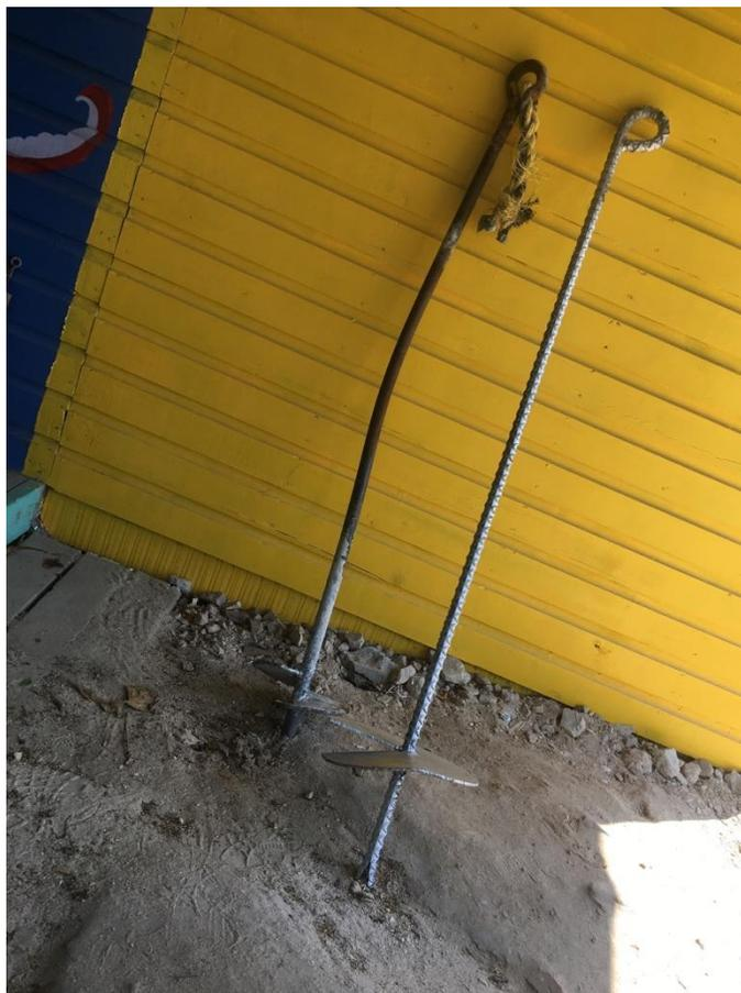
FOTOGRAFÍA 17. DOS TIPOS DE TORNILLO DE ARENA
